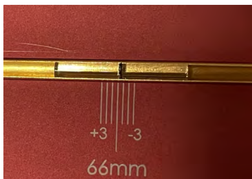
(a) Probe installiert im Probehalter, sodass das angelegte Magnetfeld parallel zur c-Achse des Kristalls verläuft
